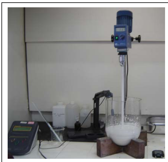
Figura 3.3 – Reator, existente nos laboratórios do CETEM, utilizado nos ensaios de alveamento químico do caulim no presente estudo.
