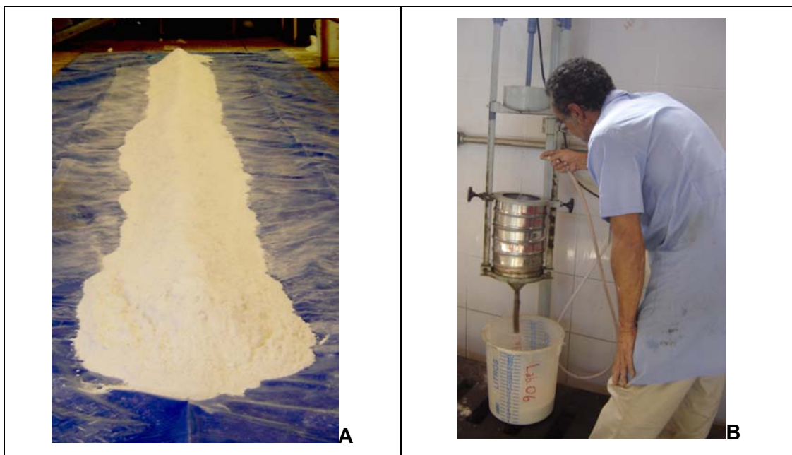
Figura 3.1 – Em (A), pilha de homogeneização da amostra de caulim e, em (B), peneirador vibratório usado nas operações de peneiramento das amostras, nas instalações piloto do CETEM.
